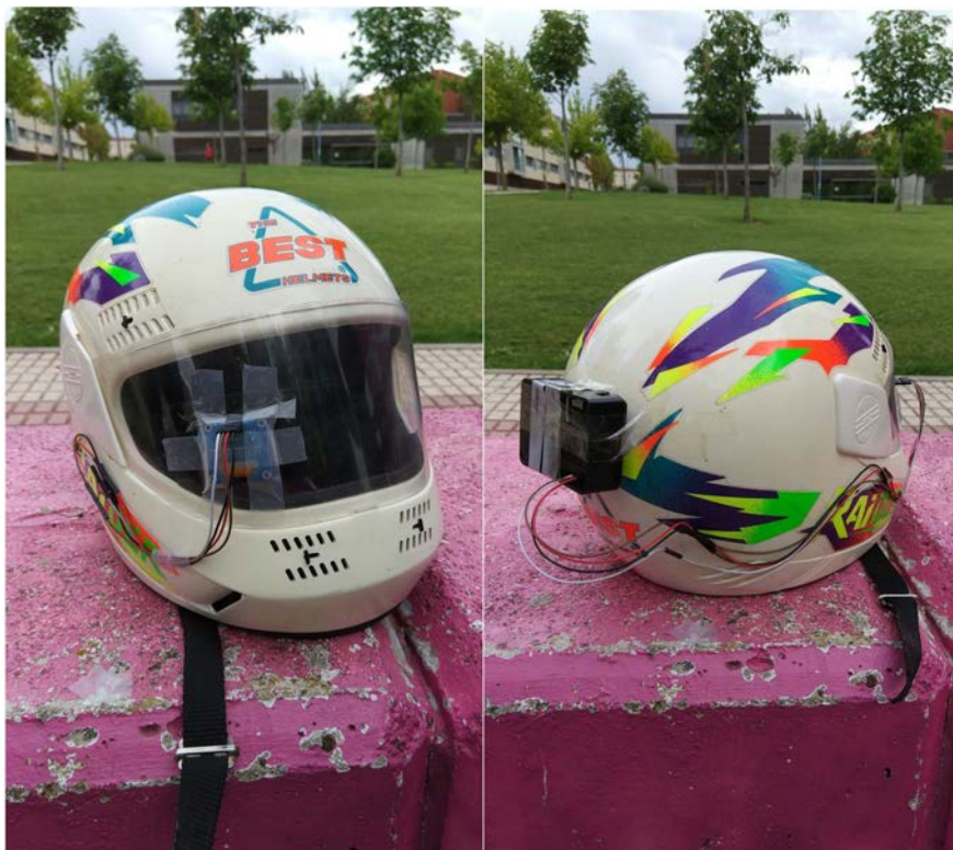
Figura 7: Montaje del dispositivo en un casco de motorista real.
