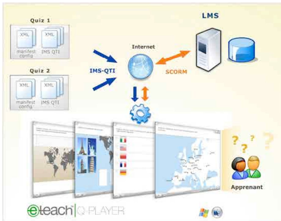
Figura 8. Diagrama de interacción del sistema Qplayer (Qplayer, 2005)
