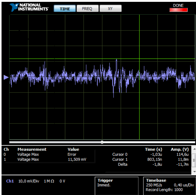
Fig. 14. Fonte CC em 6 V – Acoplamento CA – Pico: 11,8 mV.
